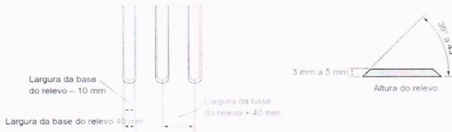
Figura 7 – Relevos táteis direcionais instalados diretamente no piso
