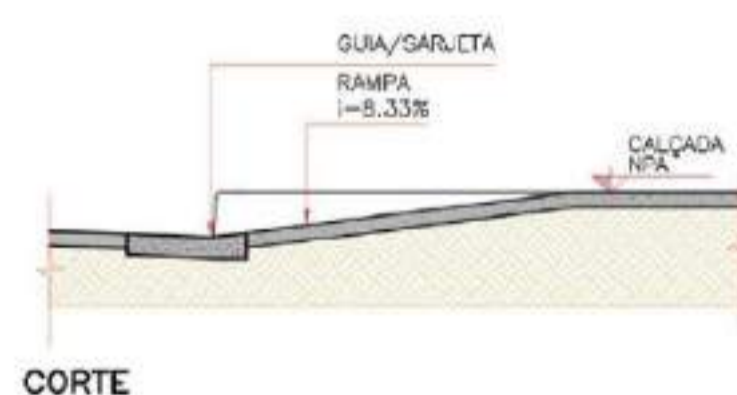
02 DETALHE DE RAMPA (CORTE) ESCALA 1:25
