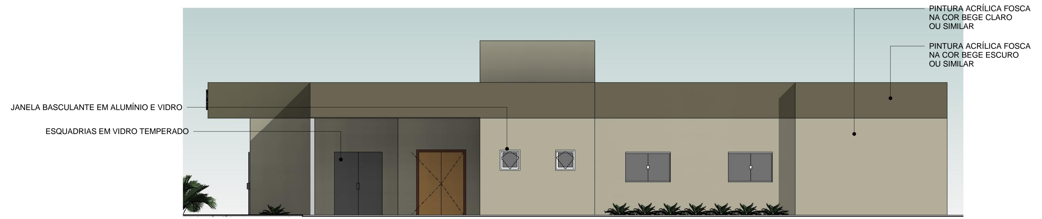
4 ELEVACÃO LATERAL ESQUERDA 1 : 75
